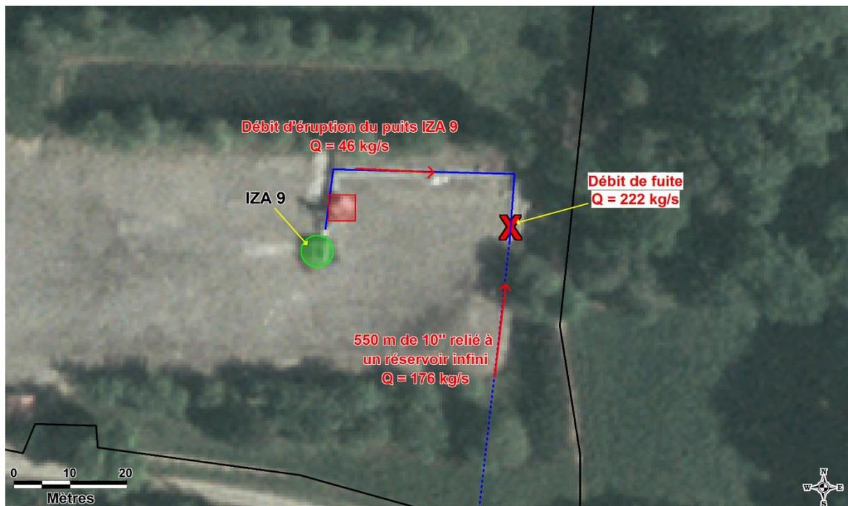
**Figure 3 : Schéma de principe des hypothèses de modélisation retenues**
