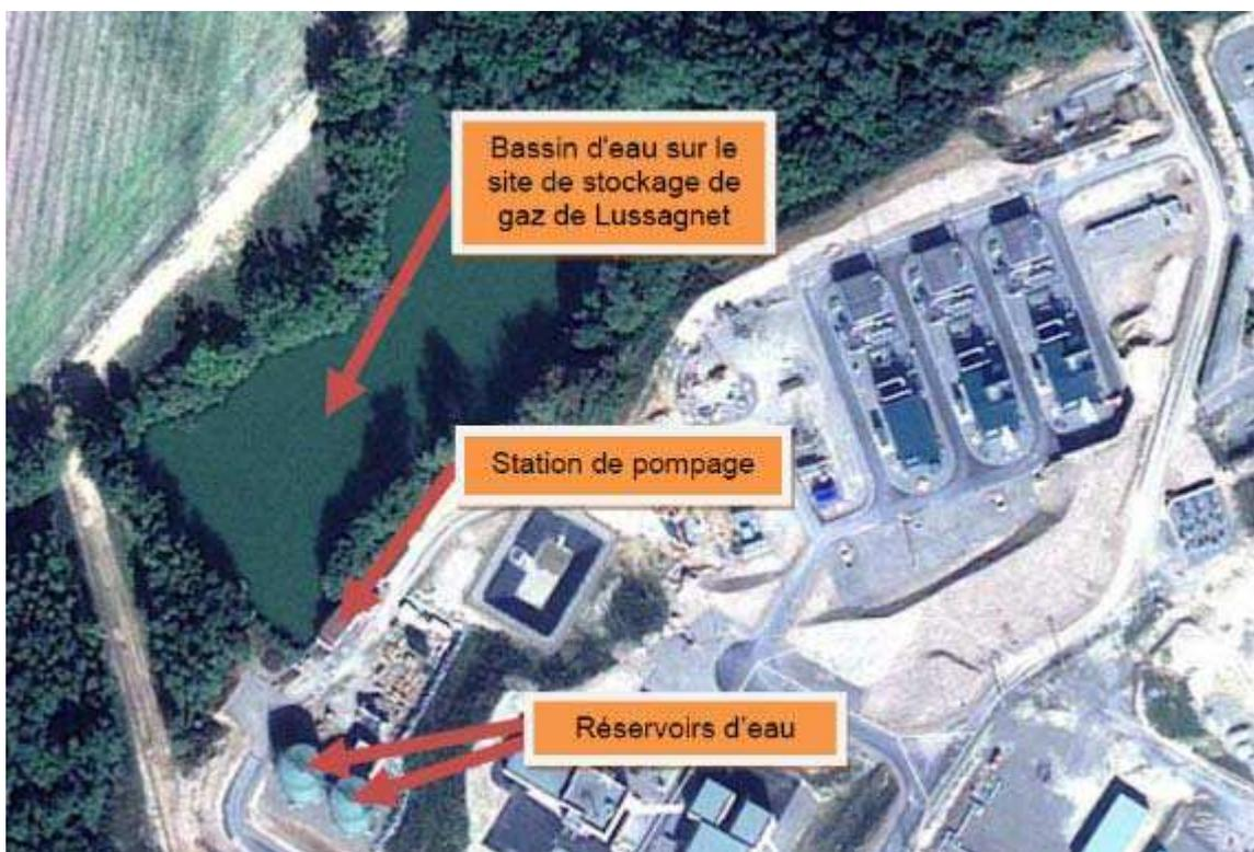
Vue d'ensemble de la réserve naturelle d'eau située au nord-ouest du site de stockage, avec station de pompage et deux réservoirs de 900 m<sup>3</sup> d'eau chacun.
