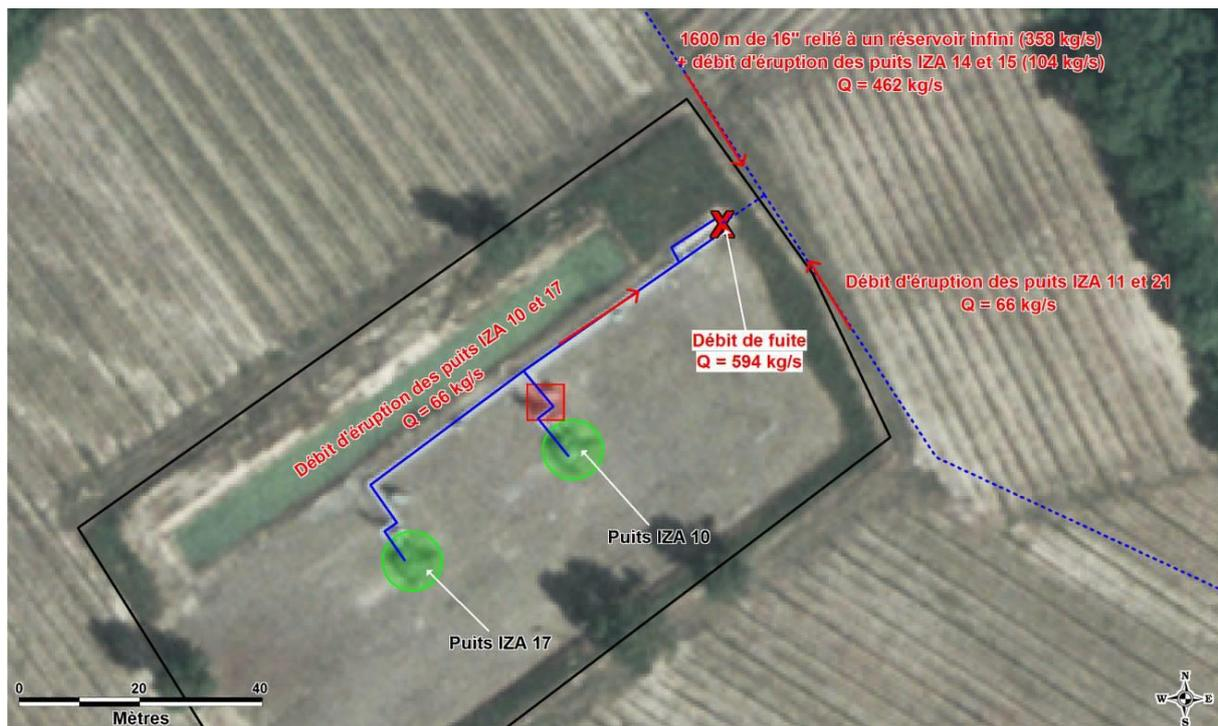
**Figure 7 : Schéma de principe des hypothèses de modélisation retenues**
