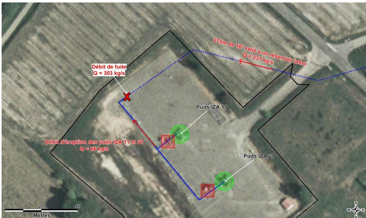
**Figure 8 : Schéma de principe des hypothèses de modélisation retenues**
